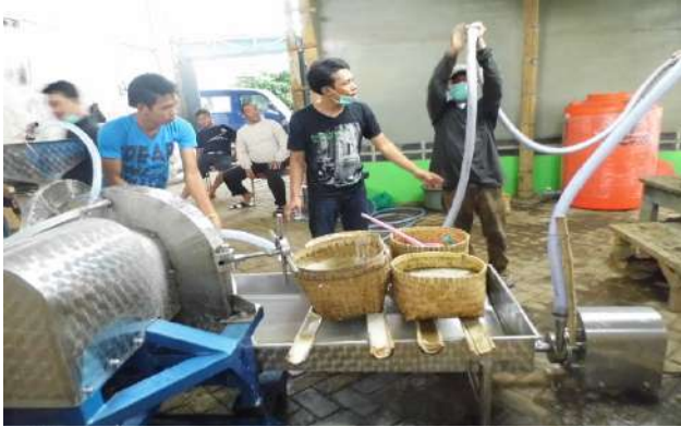
Gambar 16. Proses Uji Coba Fungsional Awal untuk Disc Mill, Dump Tank, Wash Tank, dan Pompa Impeller
