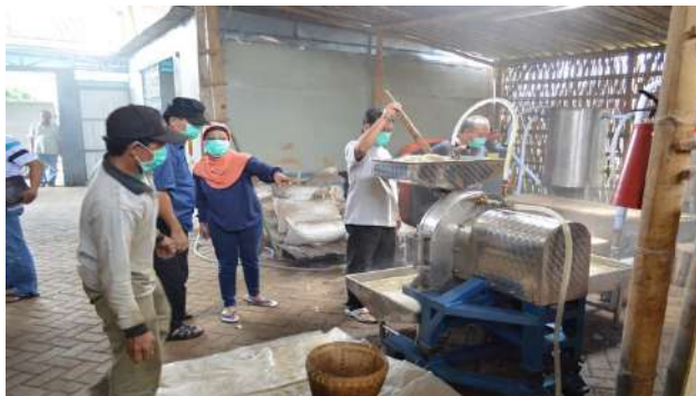
Gambar 17. Kunjungan LPPM UHT dan Reviewer Internal pada Proses Uji Coba Disc Mill, Dump Tank dan Wash Tank dengan Air Cuci 0 °Be.
