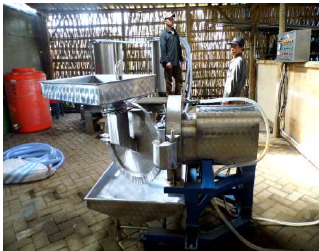
Gambar 12. Install Dump Tank dan Disc Mill
