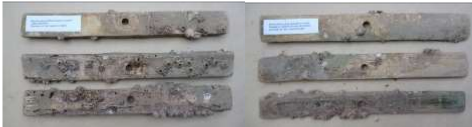
Gambar 31. Kerusakan Bambu Betung (diawetkan) terhadap Binatang Laut ( marine attack ).
