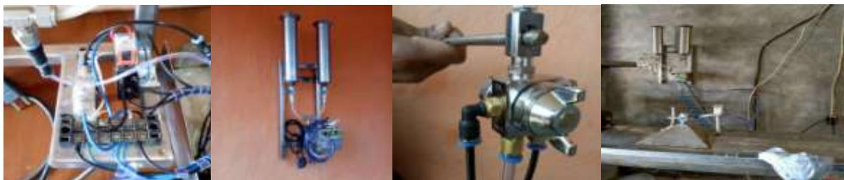
Gambar 3- Instalasi Automatic Spray Gun dengan Gravitasi Feed Container
