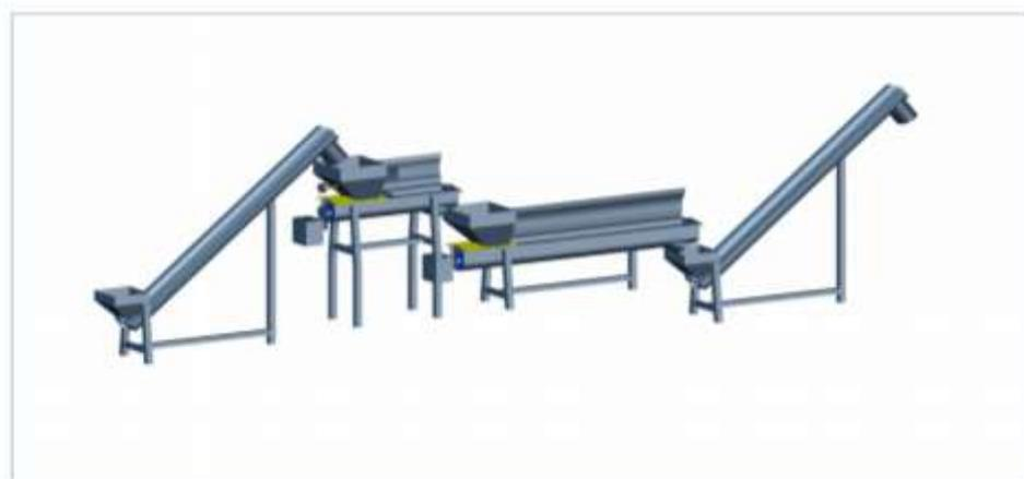
Gambar 10- Desain gambar unit mesin Screw Conveyor dengan Mesin spray yodium
