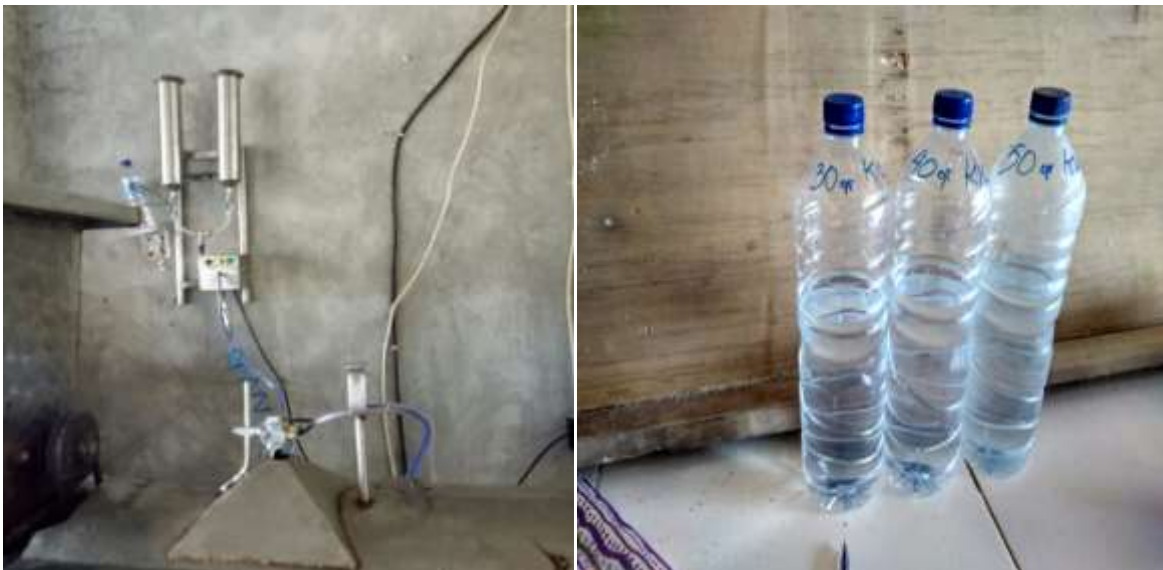
Gambar 8. Instalasi Instrumen Panel dan Sray Nozzle system karburasi dengan injeksi KIO 3 30 gr, 40 gr dan 50 gr. sudah terpasang pada mesin yodium untuk persiapan Uji Coba di PonPes Sunan Drajat Lamongan.
