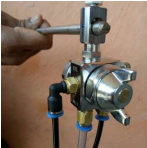
Gambar 7. Spray Nozzle dengan system karburasi dengan injeksi. Dengan sistem injeksi pengabutan tidak akan terbang dan gangguan penyumbatannya sangat kecil, sehingga pengabutannya tidak banyak yang terbang atau loses serta cairan yodium lebih sempurna.
