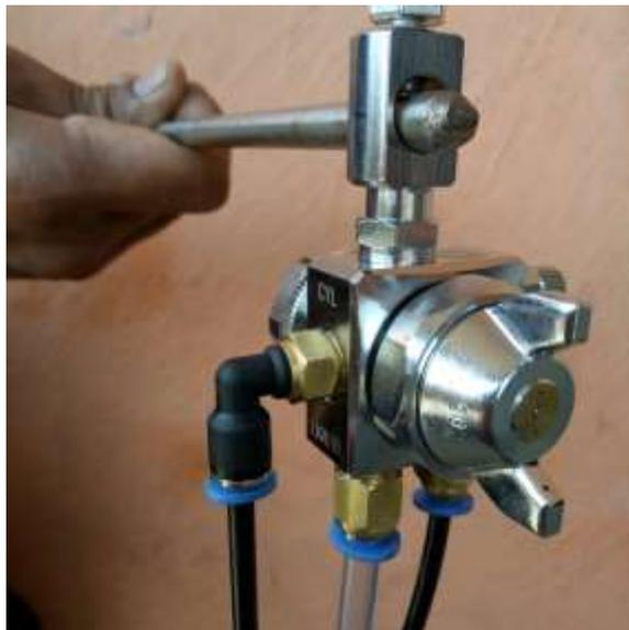
Gambar 7. Spray Nozzle dengan system karburasi dengan injeksi.
