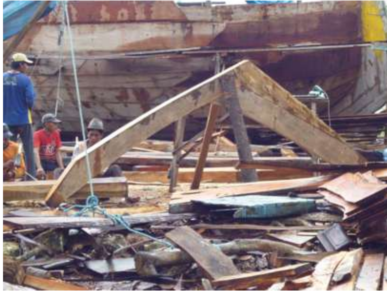
Model sambungan Lunas dengan Linggi Depan
