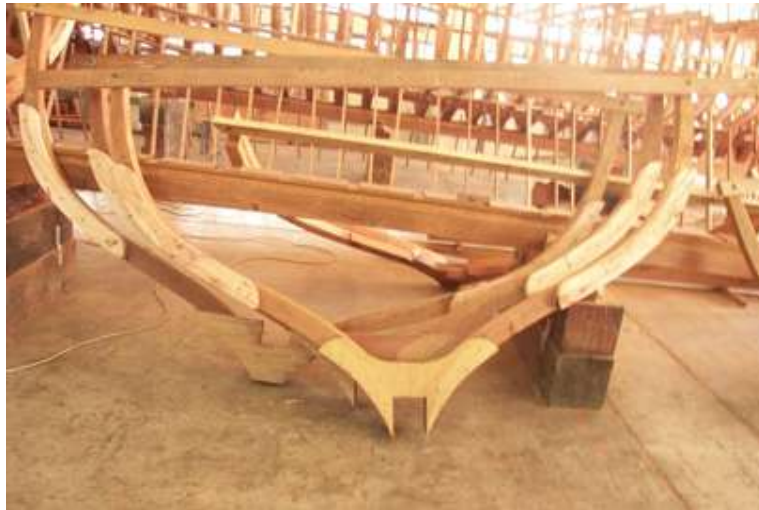
Model Sambungan Gading-2
